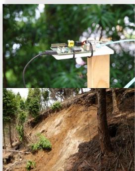
近年、未曾有の大型台風や集中豪雨によって、斜面の土砂災害が多発しています。私たちは、電気電子の技術を応用して、立ち入り困難な場所や遠隔地での災害に繋がる情報をモニタリングして、未然に災害を防ぐ技術を研究しています。この技術は、老朽化したインフラのメンテナンス費用の削減策としても期待されています。
